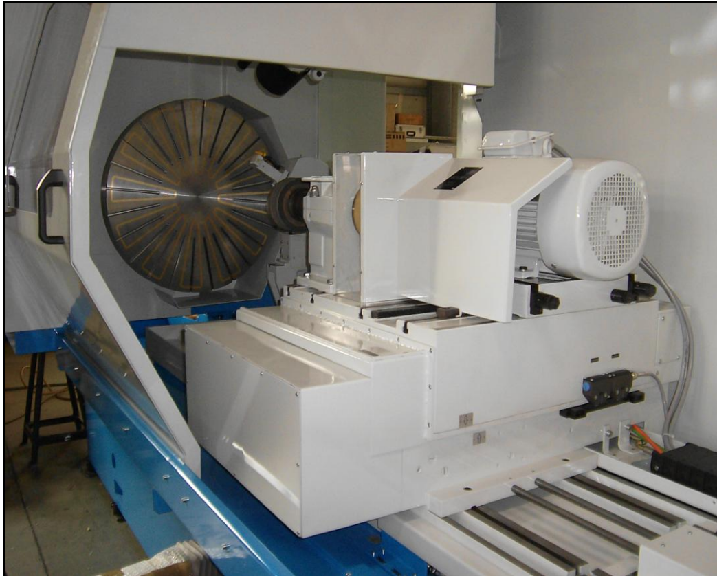
Arbeitsraum mit Elektroperm-Magnetspannplatte Ø 800 mm
